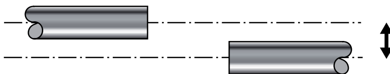
Abbildung 8: radiale Verlagerung, diese können Sie nur mit der gezeigten Anordnung abfangen
