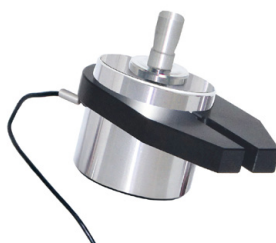
Montarea suportului la senzorul de forță
