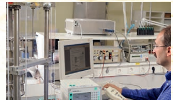
▲ Kalibrierung eines Kraftsensors an einer Kraft-Gebrauchsnormalmesseinrichtung
