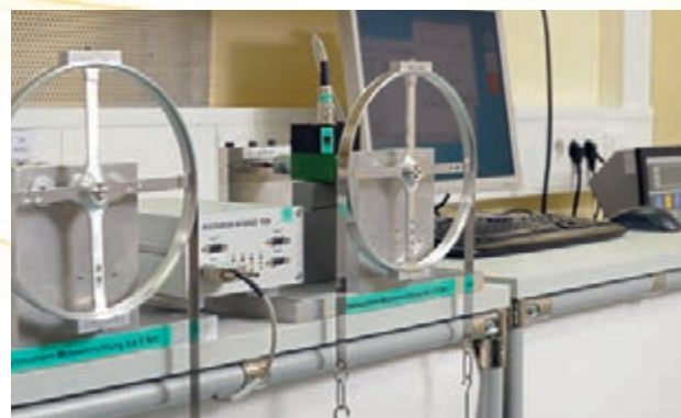
▲ Kalibriereinrichtung für rotierende Drehmomentsensoren kleiner Messbereiche
