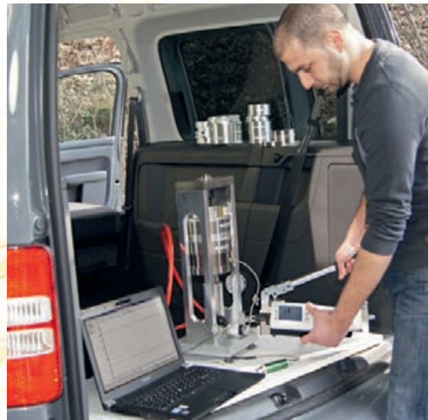
▲ Kraftkalibrierung vor Ort mit mobiler Kraftmesseinrichtung
